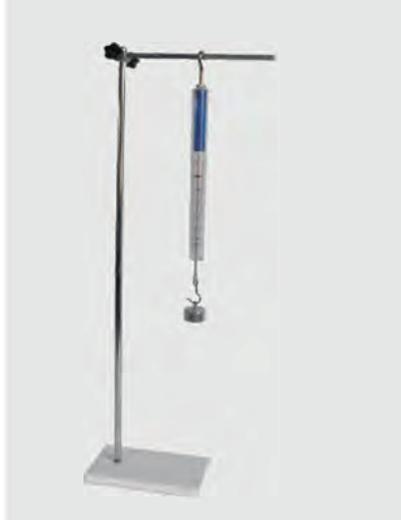
Collegando ad un'estremità del dinamometro un peso e l'altra estremità ad un'asta in sospensione è possibile vedere la diversa elasticità cambiano il peso.
